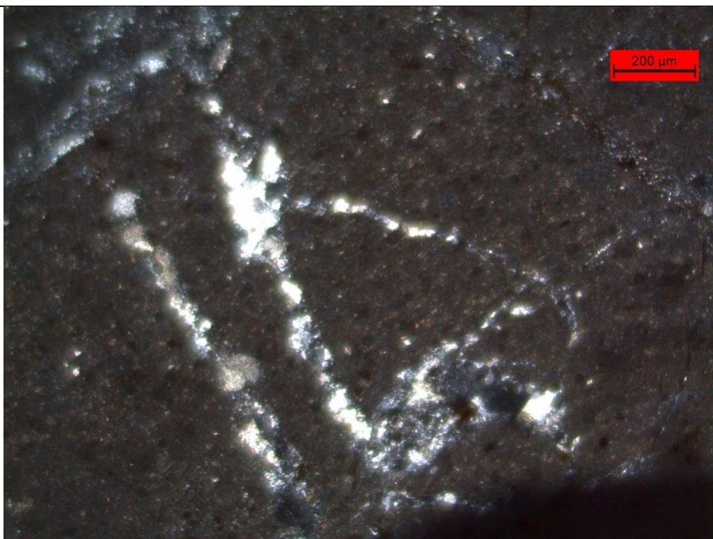
FOTOMICROGRAFIA 01: Matriz vítrea sendo brechada por vênulas de sílica – polarizadores cruzados
