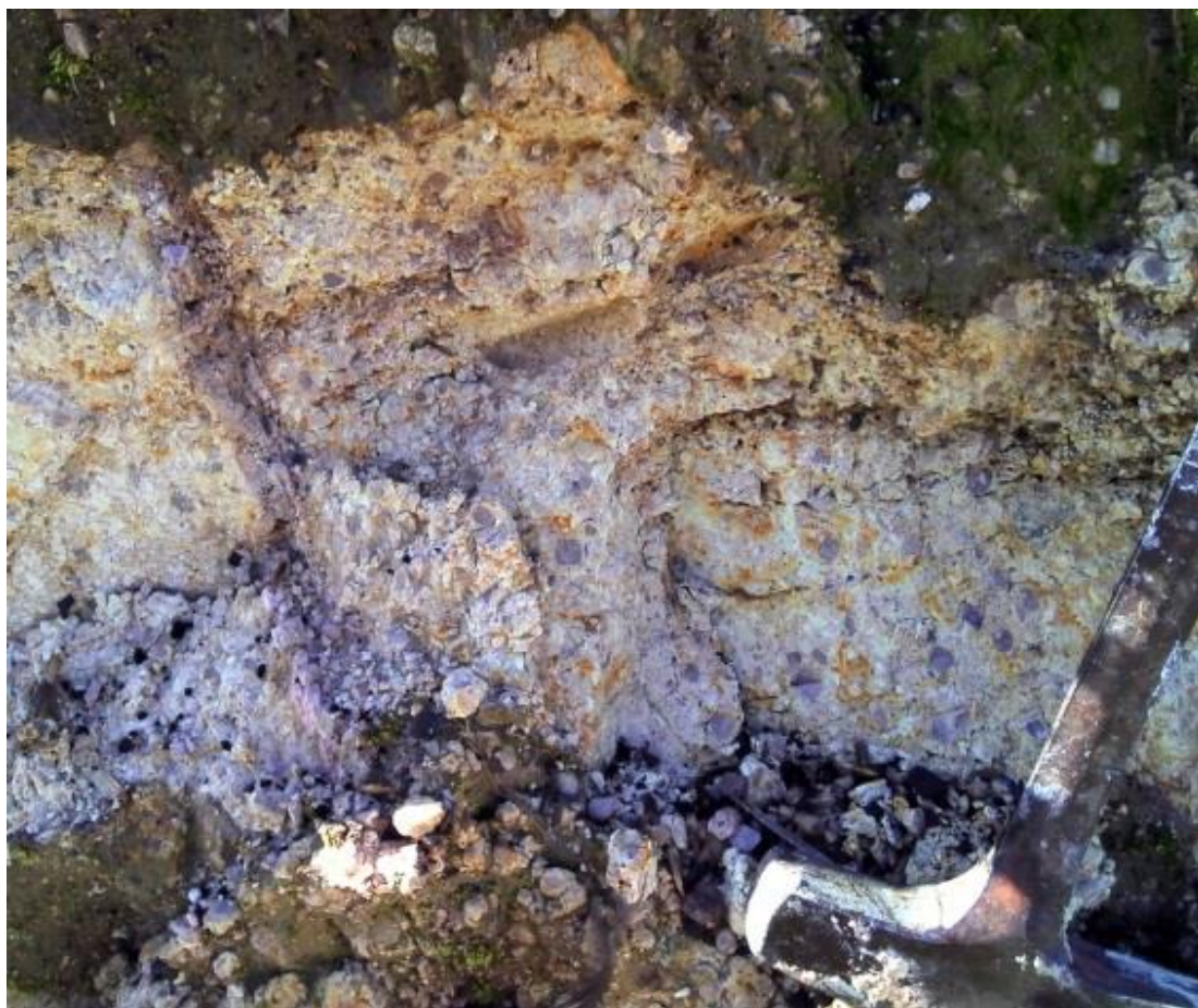
Foto 11 - Quartzo-feldspato pórfiro caulinizado em meio a valeta de drenagem (Ponto TP-VS-0406).
