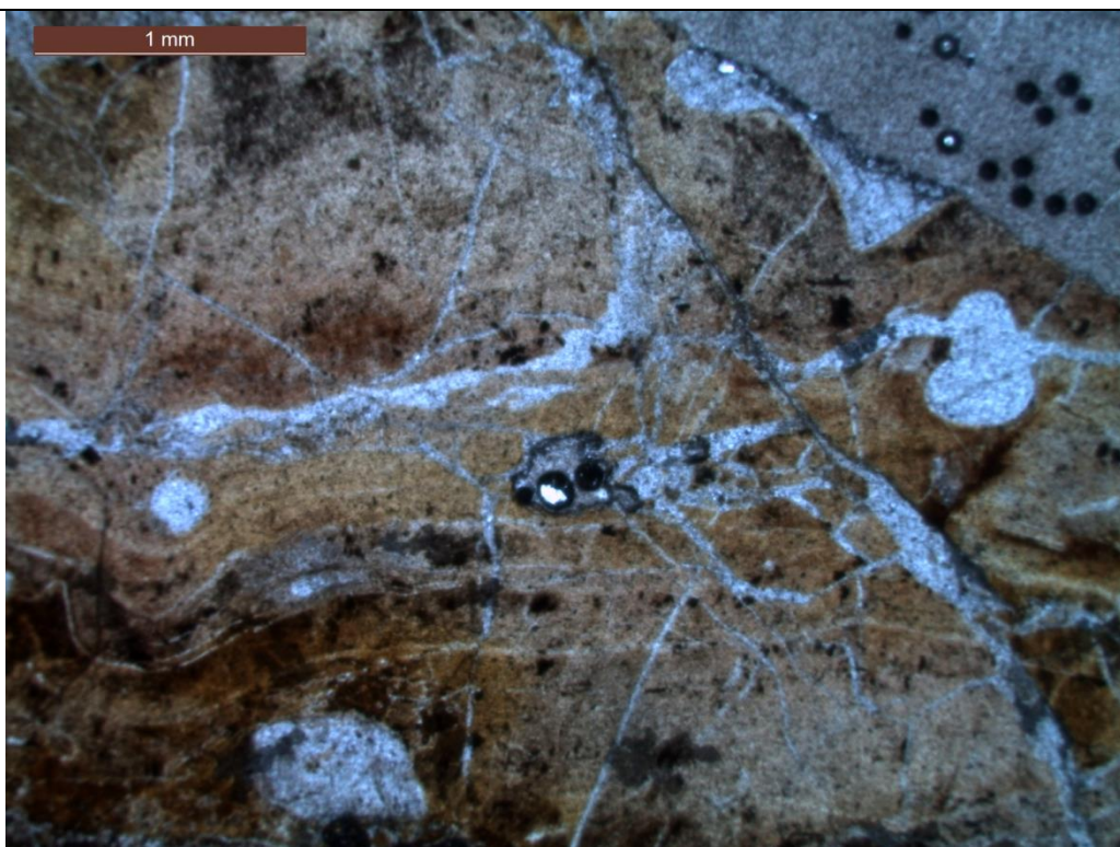
FOTOMICROGRAFIA 07: Vênulações na forma de stockwork no meio do bandamento riolítico – polarizadores descruzados
