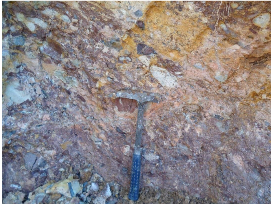
Foto 12 - Lahar com clastos imbricados indicando o acamamento (Ponto TP-VS-0378).
